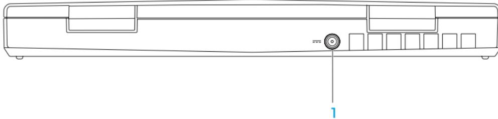
**موصل محول التيار المتردد** 1 - يتصل بمحول التيار المتردد لإمداد الكمبيوتر بالطاقة وشحن البطارية.
